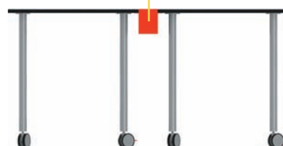
calha horizontal para cabos horizontal cable tray
